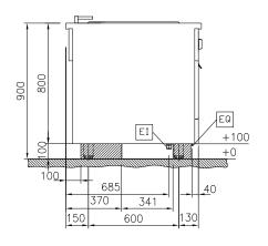
ΕI Electrical inlet (power) Equipotential screw EQ Water inlet
